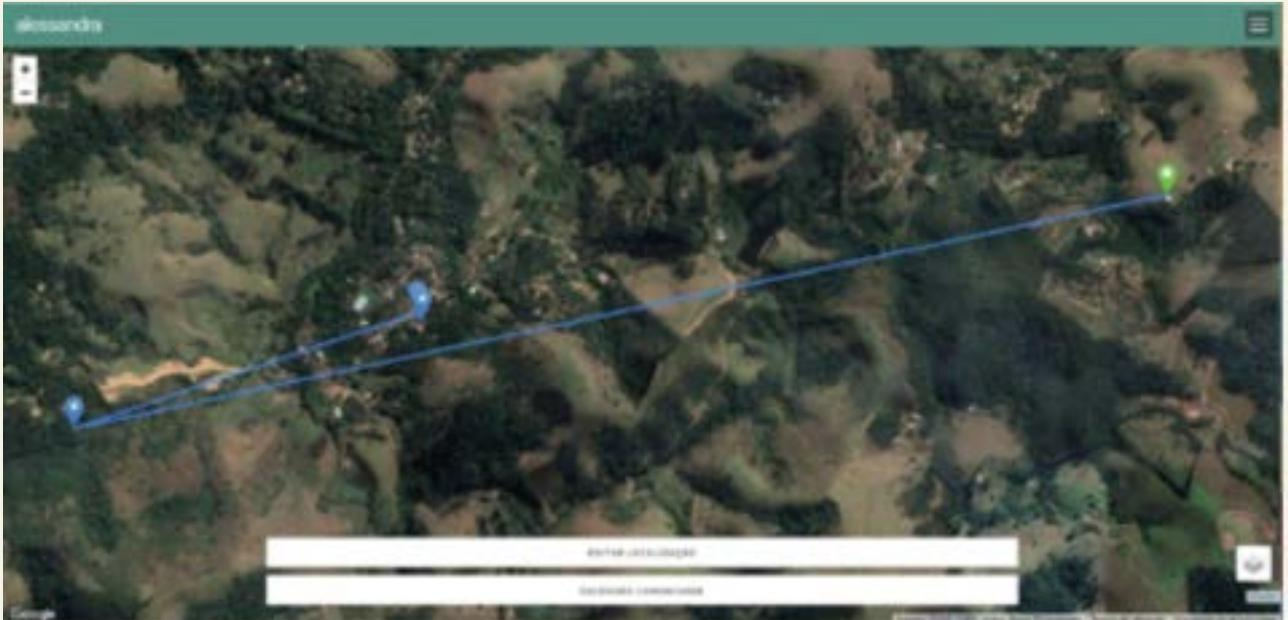
El mantenimiento básico del sistema, como la alineación de nodos, se puede hacer a través del menú "alinear" de LimeApp, donde se puede encontrar qué nodos están conectados a ese router y cuál es su calidad de conexión.
